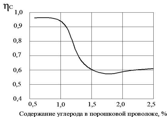
Рис. 2. Изменение коэффициента перехода углерода в зависимости от содержания углерода в порошковой проволоке
